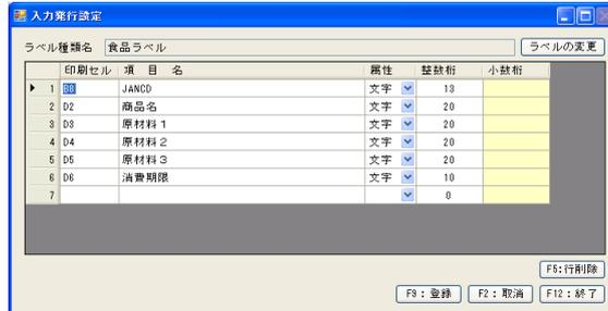
ラベルのレイアウトはExcelを利用するので簡単！バーコードの指定もフォントの定義でできます。レイアウトが完成したら、ExLABELでどのセルに何を印刷するかを定義するだけで主な設定は終了です。
